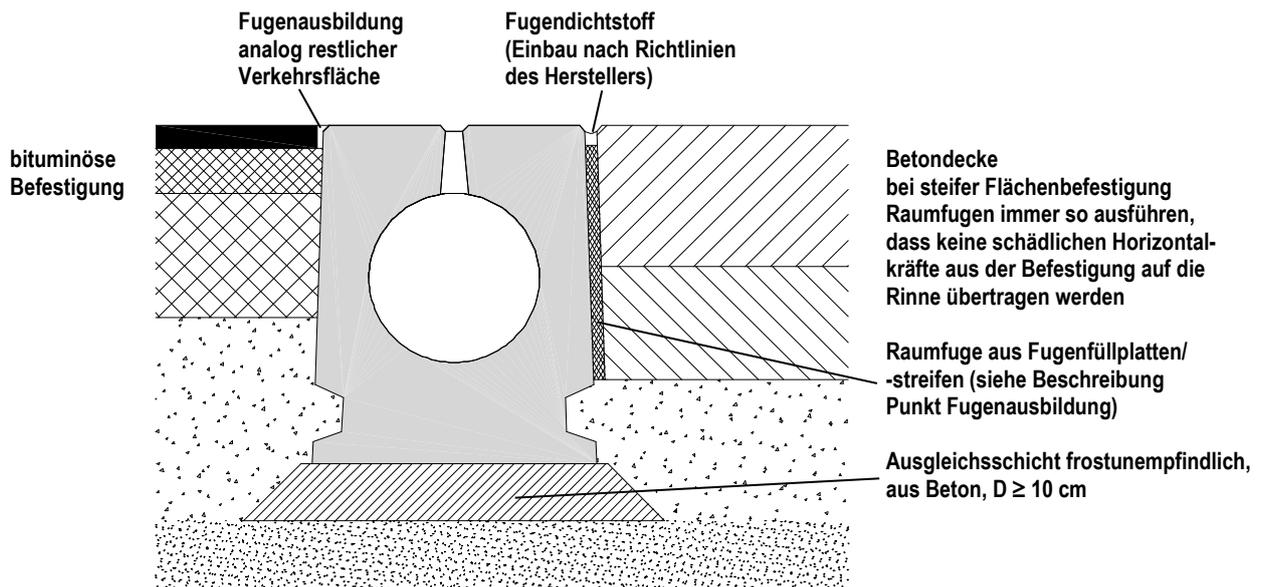
Gründung auf frostunempfindlichen Boden (F1), Materialien und Verdichtungswerte Baugrund nach den einschlägigen Regelwerken des Straßen- und Verkehrswegebau entsprechend der Belastungsklasse und Bauart der Verkehrsfläche
