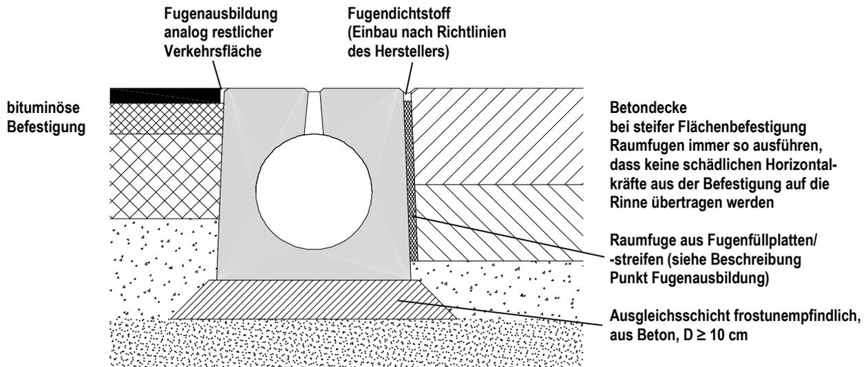
Gründung auf frostunempfindlichen Boden (F1), Materialien und Verdichtungswerte Baugrund nach den einschlägigen Regelwerken des Straßen- und Verkehrswegebau entsprechend der Belastungsklasse und Bauart der Verkehrsfläche
